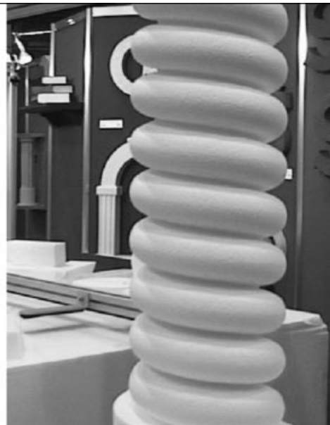
Obyčejný žhavý drát dokáže z polystyrénu vykouzlit neuvěřitelné tvary.
