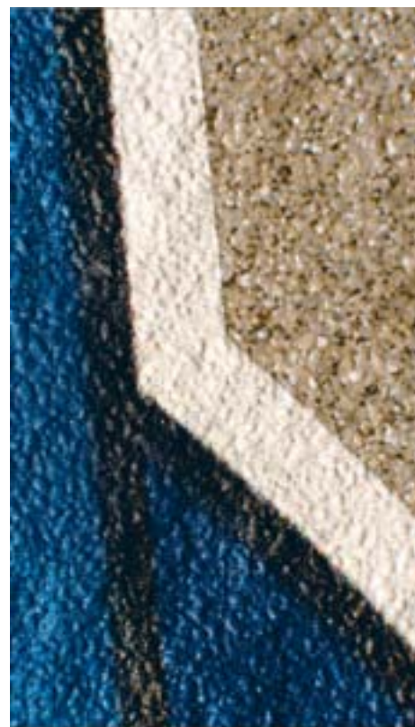
Ukázka tisku bílou barvou na dlaždici. Vlevo vidíte celý motiv a vpravo detail, na němž je pěkně vidět nejen bílý inkoust, ale také schopnost tiskárny potisknout hrubý povrch.
