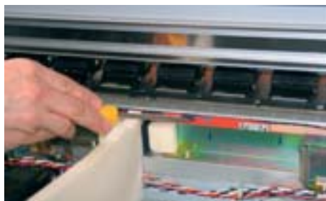
Nové topení pod dráhou tiskových hlav výrazně zvyšuje kvalitu tisku
