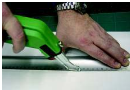
Práce s horkým nožem se o moc neliší od běžného řezání. Vyžaduje však kovové pravítko.
