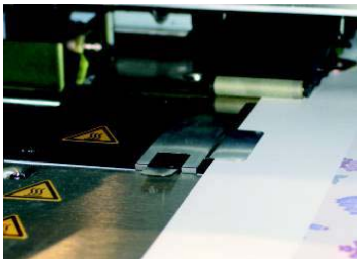
Přísávání média spolu s posuvným vedením pomáhá udržet rovinnost potiskovaného papíru
