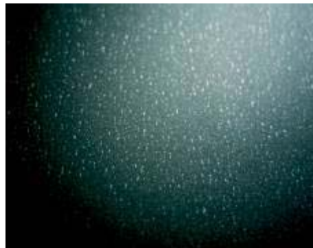
Příklad silveringu nevhodného polomatného fotopapíru v kombinaci s Neschen Filmolux Satin. Výsledek je lepší než předchozí, ale silvering je stále zřetelný. Silvering zmizí přibližně po 3 týdnech. Zvětšeno.
