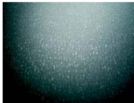
Příklad silveringu při použití nevhodného polomatného fotopapíru v kombinaci s nevhodnou matnou laminací. Zvětšeno.
