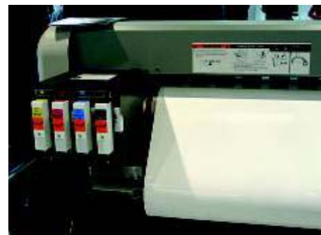
Tiskárna pracuje v systému míchání barev CMYK a poskytuje maximální výkon 7,2 m 2 /hod
