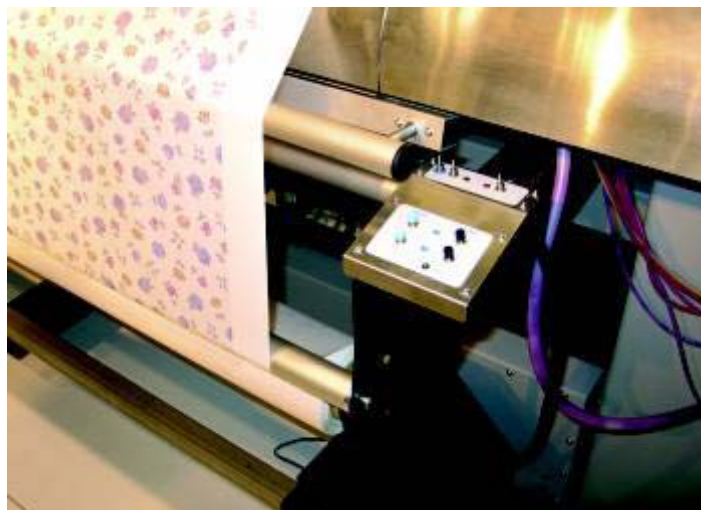
Dalším konstrukčním prvkem, díky kterému je transferový papír dostatečně napnut, je odvíjecí zařízení a napínací válec, tvarovaný do jemného oblouku
