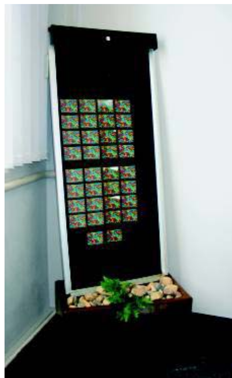
Testovací stěna. Poškozené vzorky ve třetím sloupci patří interiérovému vinylu s dye based inkousty a v testu byly použity jen pro srovnání (do exteriéru samozřejmě nepatří). Všechny laminace na exteriérových materiálech přečkaly test bez viditelných změn.
