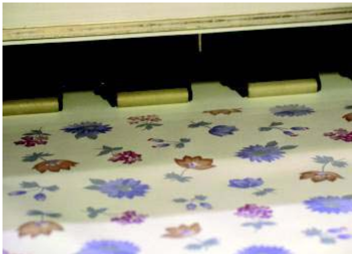
V místech, kde se v důsledku velkého krytí inkousty papír příliš vlní a mohl by se dotýkat tiskové hlavy, lze zvednout příslušný přítlačný váleček, a uvolnit tak vznikající zvlnění
