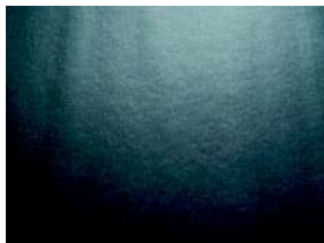
Také výborný výsledek. Takto vypadaly všechny laminace v kombinaci s obyčejným coatovaným papírem (zde s InteliCoat 130g Paper). Vzduch má kudy uniknout, a silvering se proto téměř nevyskytuje. Zvětšeno.
