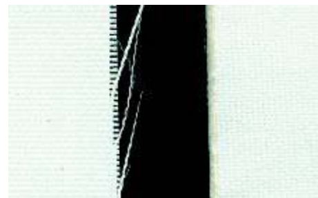
Ustříhnutý okraj textilu se nepříjemně třepí. S využitím horkého nože dochází k zatavení okraje a další zpracování textilu z umělých vláken je velmi pohodlné.
