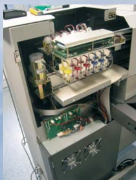
Pro případnou výměnu elektroniky již není nutno vymontovat všechny desky
