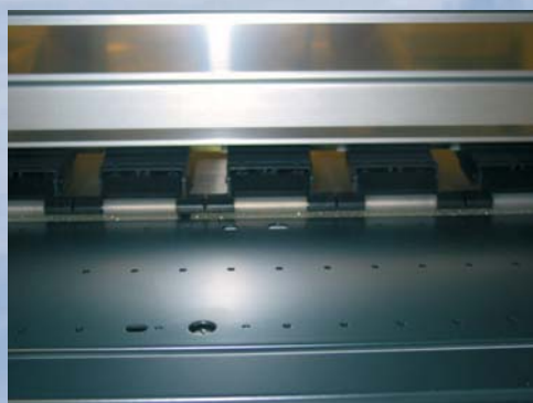
Vedení média ve stroji vylepšuje přítlačná lišta nové konstrukce, která umožňuje nastavení 3 ° přítlaču
