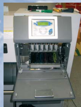
Parkovací stanice poskytuje dobrý přístup k tiskovým hlavám
