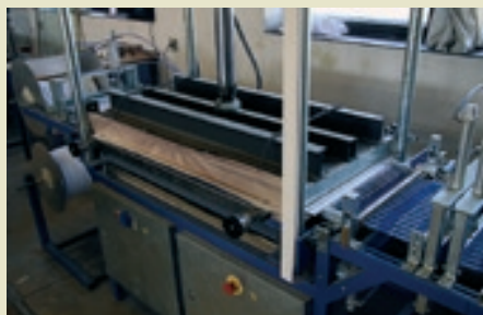
3/ Po uzavření termolisu proběhne za působení tlaku a vysoké teploty proces sublimace
