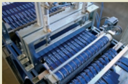
4/ Textil je dokonale probarven, protože barvivo se stalo součástí molekulární struktury textilních vláken
