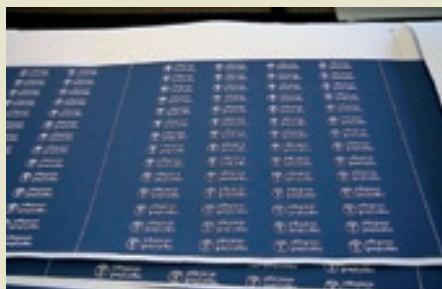
1/ Grafika je zrcadlově vytištěná na termotransferový papír
