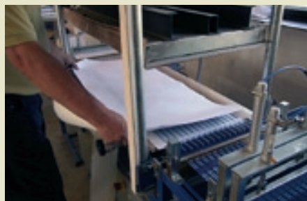
2/ Grafika se položí potištěnou stranou na textil
