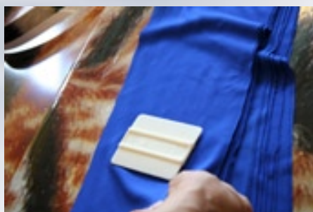
1/ Odstříháme pruh pevné polyesterové látky širší než stěrka.
