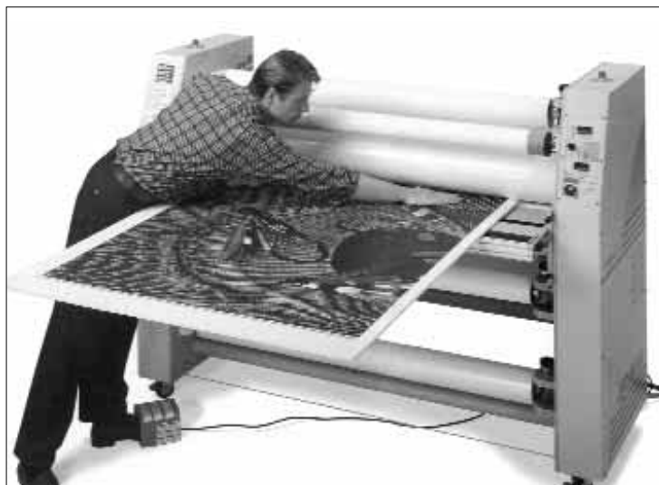
Pomocí laminátoru GBC Pro-Tech Orca 1 lze snadno kašírovat tisky i na 4 cm silnou desku o šíři až 140 cm.
