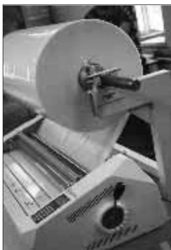
Úprava GBC Eagle 65 s vyhřívaným válcem pro termolaminaci.
